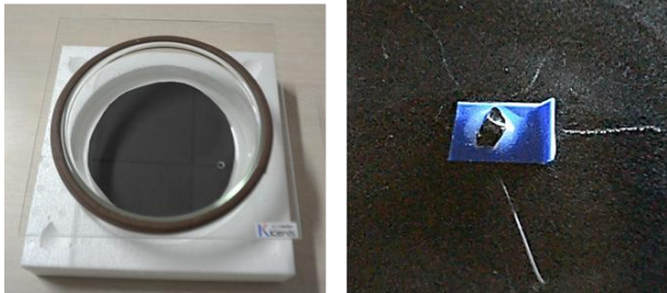
図1 拡散型霧箱一式（左）と \alpha 線の可視化（右）
